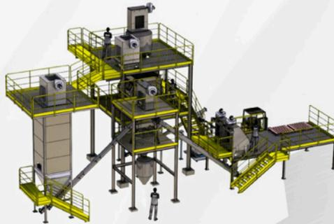
O sistema de transporte pneumático em fase densa linha cheia Biasetec mantém a tubulação completamente preenchida, otimizando o tempo de produção.
