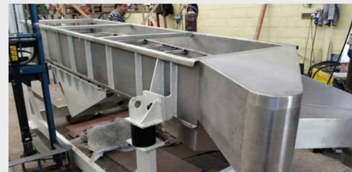
Funciona com uma malha de tela que realiza a separação de forma eficiente. É indicada para produtos a granel como cal, areia, argila, farinhas, pó de ferro, resinas, talco, leite em pó, açúcar, entre outros.
