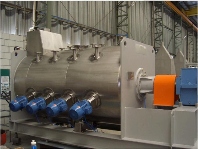
O Misturador Intensivo Horizontal é um equipamento de alta eficiência de mistura. Projetado e fabricado em diferentes tamanhos e em diferentes produtos. Com o objetivo de atender às demandas de cada cliente, de acordo com a sua necessidade.
