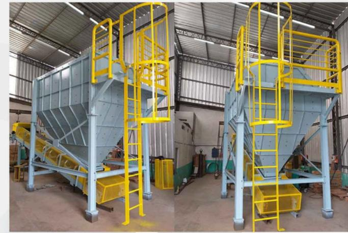
Fabricada sob medida, atende às necessidades específicas da linha de produção do cliente, com diferentes capacidades de volume e materiais como Aço Inoxidável 304, 316 ou A36, podendo também contar com revestimentos especiais.
