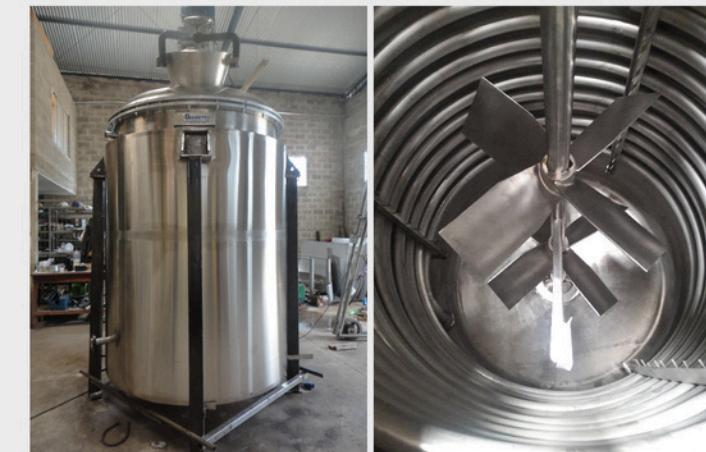
Reatores de Mistura são tanques pressurizados de mistura, onde ocorrem reações químicas, transferências de massa e calor, o que resulta em economia e eficiácia no processo.
